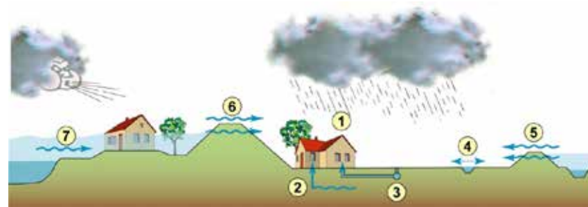
Figuur 1. Verschillende soorten wateroverlast (1: Neerslag direct in woning, 2: Hoge grondwaterstanden 3: Overlopende rioleringen 4: Overlopen van sloten en lokale watergangen 5: Doorbreken van regionale waterkeringen 6: Doorbreken van primaire waterkeringen en 7: Buitendijks. (bron figuur is Leven met Water, project van neerslag tot schade).
