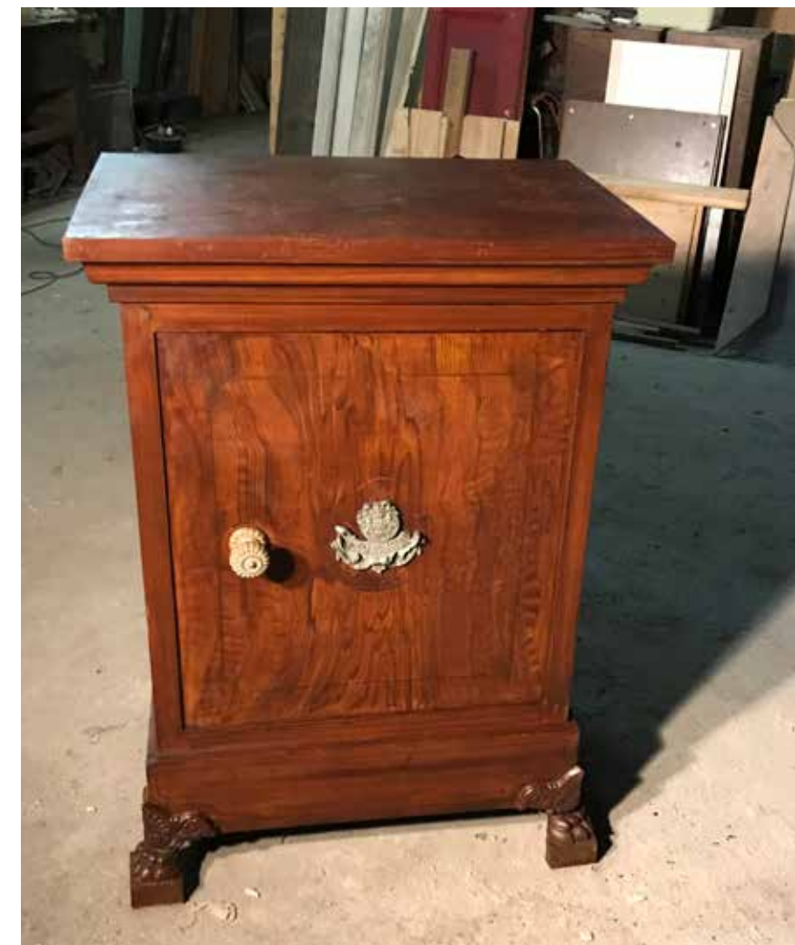
Voorbeeld van het conform de restauratieladder ‘ontstoren’ (het weghalen van in het oog springende vlekken met intactlating van het ‘patin’) van een brandkast waarvan de buitenzijde in een mahonie-imitatie is geschilderd.
