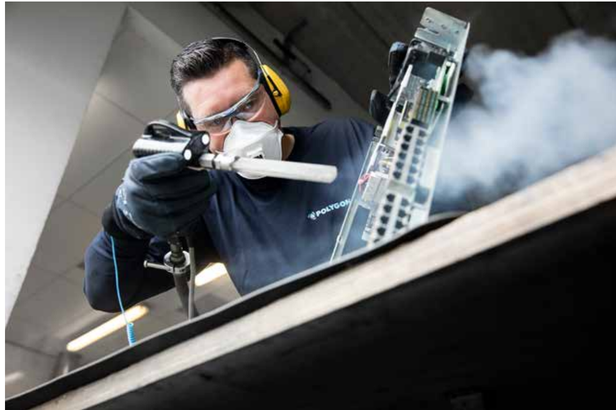
Polygon doet ook aan technische reconditionering, waaronder herstel van elektronica door middel van 'droogjstralen'.
